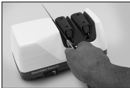
Abbildung 3. Stufe 1. Einführen der Klinge in den Schlitz zwischen der Führung und der Elastomerfeder. Abwechselnd durch den linken und rechten Schlitz ziehen.
