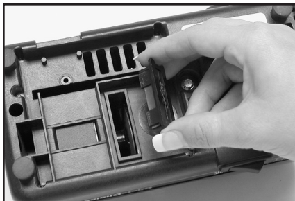
Abbildung 10. Reinigen Sie die Abdeckung unter dem Schärfgerät.
