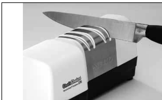
Rys. 5 Umieszczenie noża w prawym slocie w Etapie 2.
